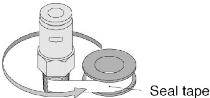
3. Khi siết ren loại nhựa cho đường ống, hãy siết chặt cho đến khi dùng bằng tay, sau đó dùng dụng cụ như cờ lê vặn chặt khoảng 2 đến 3 vòng. Khi đó, vặn quá chặt có thể gây hỏng ốc. Siết chặt không đủ có thể gây ra lỏng lẻo và rò rỉ.
