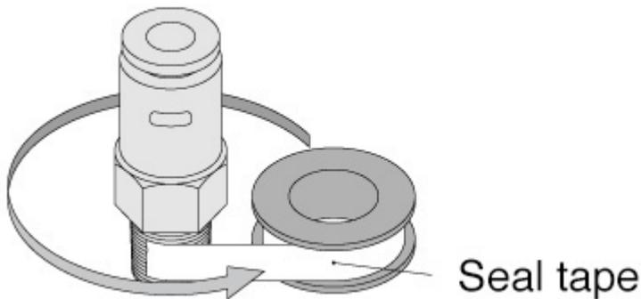
3. Khi siết ren loại nhựa cho đường ống, hãy siết chặt cho đến khi dừng bằng tay, sau đó dùng dụng cụ như cờ lê vặn chặt khoảng 2 đến 3 vòng. Khi đó, vặn quá chặt có thể gây hỏng ốc. Siết chặt không đủ có thể gây ra lỏng lẻo và rò rỉ.
