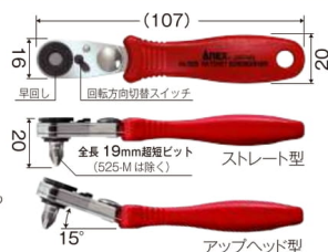
極薄ヘッド20mmで狭い所でもスムーズにネジが回せる。
